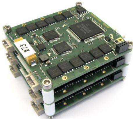
微型驱动板 v2 - 堆叠 3 张卡 - 重量: 47g(定制电子板)
